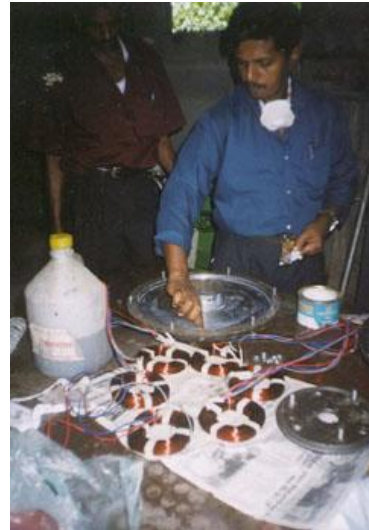
Figure 5 : Fabrication d'un générateur à aimant permanent au Sri Lanka. Photo : Practical Action Asie du Sud.
