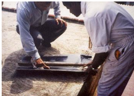
Figure 4 : M. W.A. Fernando, de Dinusha Marine Works, à Panadura, fabriquant des pales pour petits systèmes éoliens. Photo : Practical Action South Asia.
