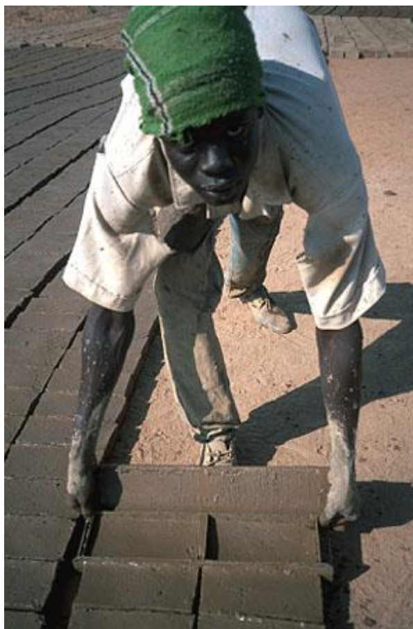
Figura 3: Producción de ladrillos utilizando un horno mejorado en Kassala, este de Sudan. Liberación de moldes y colocación de ladrillos para el secado.
