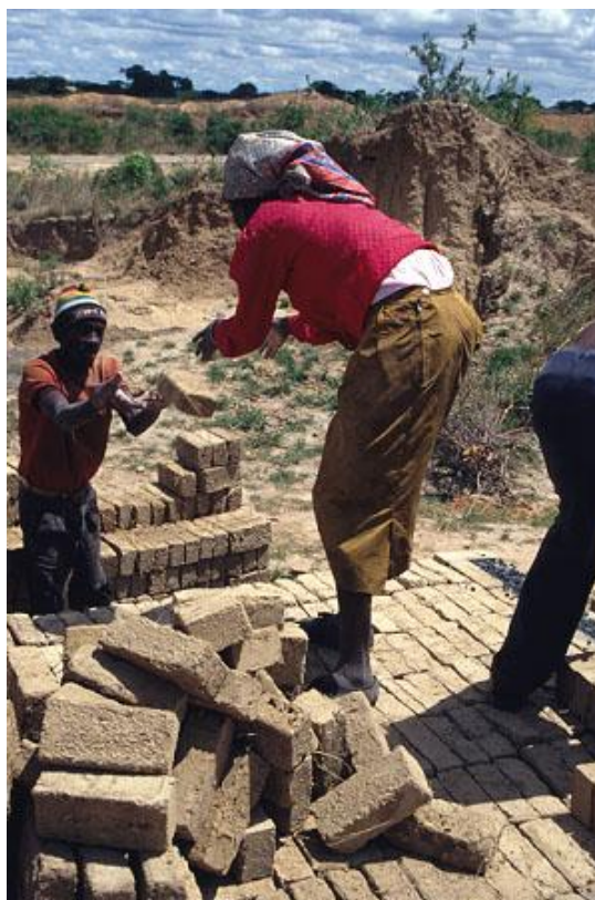
Figura 2: Fabricantes de ladrillos construyendo el horno para la quema, Zimbabwe. Foto: Practical Action / Janet Boston.
