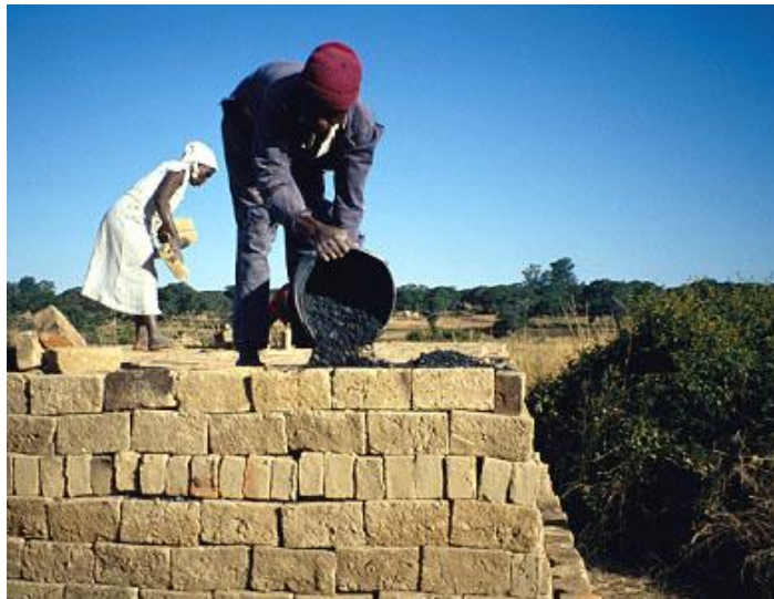
Figura 1: Residuos de caldera son cribados y utilizados como combustible para la cocción en hornos de ladrillos en la Cooperativa Kurewasekwa en Epworth, Harare. Foto: Practical Action / Theo. Schilderman.
