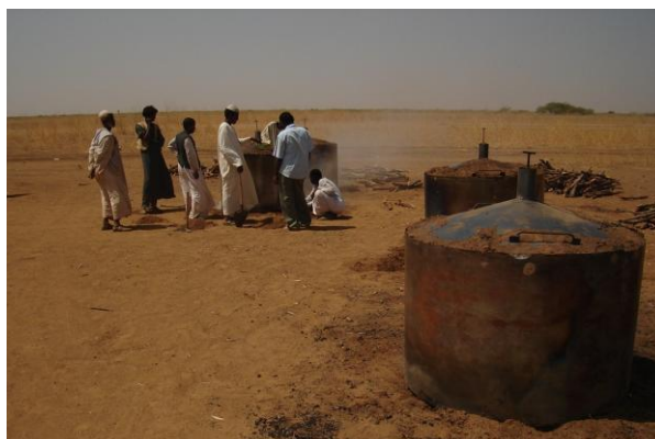
Figure 2: Utiliser un four portable en acier au Soudan. Photo: Practical Action Sudan.
